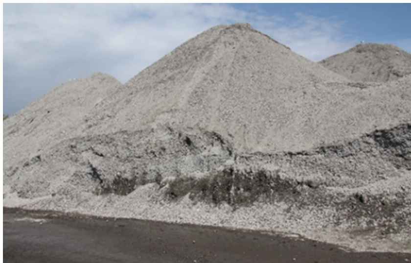
Modning af slaggen i 2 – 3 måneder giver tør slagge på 10 – 12 % fugtindhold - tilstrækkeligt til effektiv frasortering af metaller.
