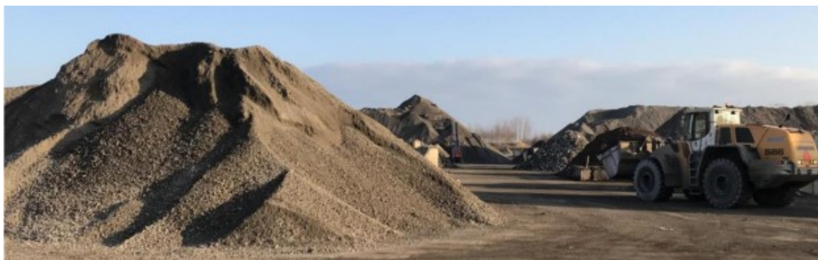
Oparbejdet slagge – færdigt, certificeret slaggegrus
