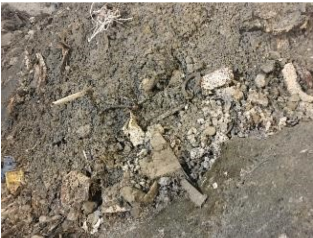
Et eksempel på råslagge efter nedkøling med vand.
