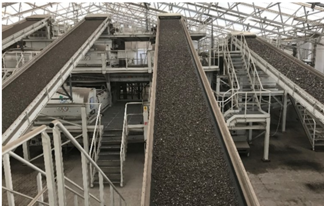
Tør slagge fugtindhold på 10 – 12 % giver mulighed for frasortering af metaller ned til 1 mm og for samlet at give en høj genvindingsgrad af ikke-magnetiske metaller som kobber, messing, zink, aluminium og ædle metaller som guld og sølv. I visse tilfælde frasorteres også rustfrit stål.
