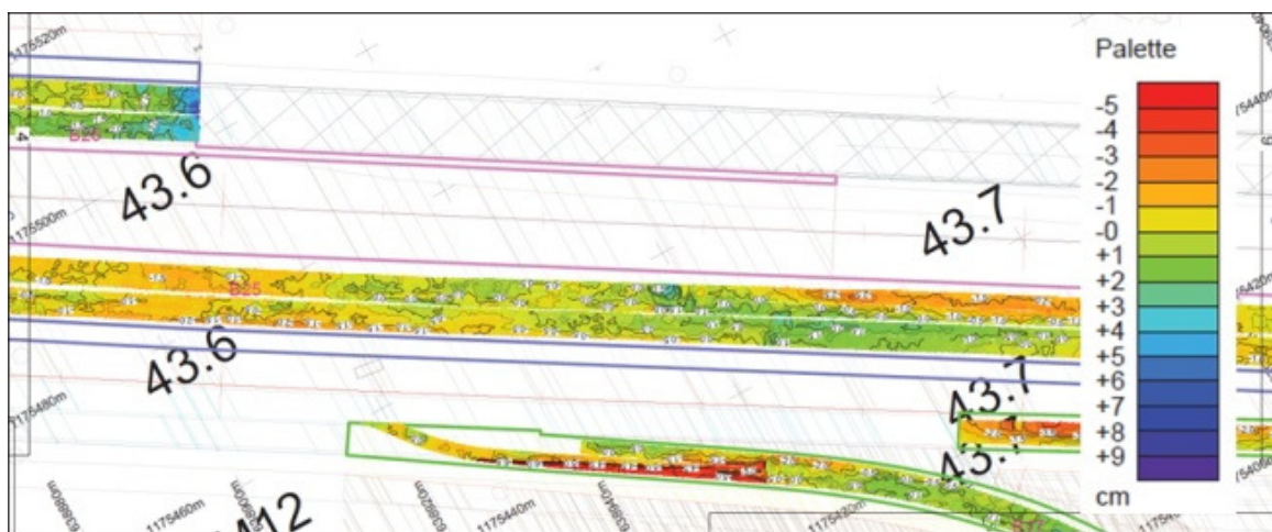
Figur 2- Udsnit af et differenskort med farvepalette, der viser hvor der er udlagt asfalt i for lille eller stor tykkelse i forhold til det projekterede
