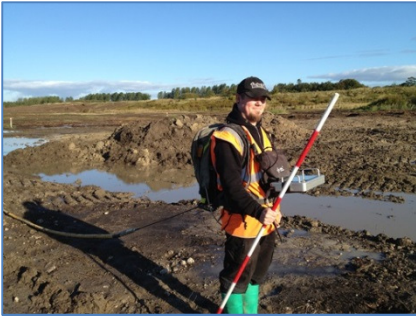
Figur 1: Specielt udstyr til georadarundersøgelse af blødbundsområder. "Slangen" som man trækker efter sig, sender elektromagnetiske bølger med en frekvens på 0,5 GHz ned i jorden. Bølgerne reflekteres forskelligt i forskellige jordlag, og de målte refleksioner tegner et billede af jordens opbygning
