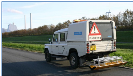
Figur 1: Specielt udstyr til georadarundersøgelse af blødbundsområder. "Slangen" som man trækker efter sig, sender elektromagnetiske bølger med en frekvens på 0,5 GHz ned i jorden. Bølgerne reflekteres forskelligt i forskellige jordlag, og de målte refleksioner tegner et billede af jordens opbygning
